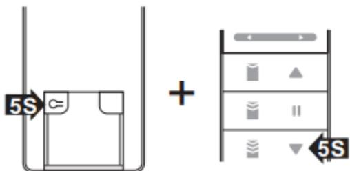
Pressione (Abrir) até que chegue no ponto ideal para definir o controle de parada, depois pressione os botões (Abrir) + (Prog C.R) juntos por 5 segundos até que o piloto faça um leve movimento para frente e para atrás, o Led no motor ira acender, aperte o botão no motor para finalizar a programação.
